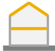
Bâtiment murs lourds + plancher/charpente bois
