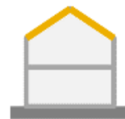
Bâtiment murs/plancher lourds + charpente bois
