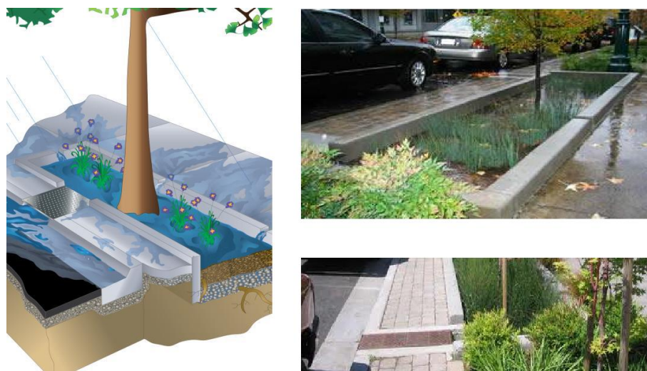
Figure 3 : les fosses d'eau pluviale agissent comme de mini réservoirs au pied des arbres de pluie
