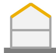
Bâtiment murs/plancher lourds + charpente bois
