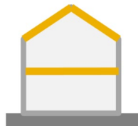
Bâtiment murs lourds + plancher/charpente bois
