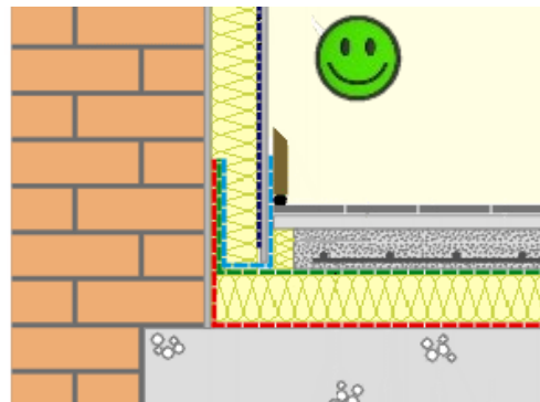
Raccord mur/dalle Source: énergie +
