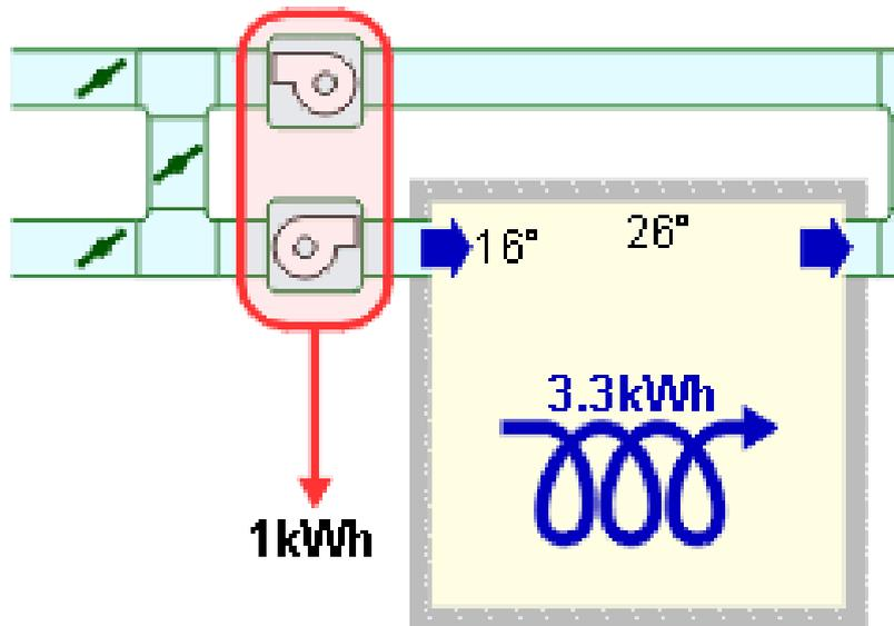
Apporter la même quantité de froid par la ventilation avec un rendement énergétique au minimum équivalent au groupe de froid nécessite un  $\Delta T > 8^\circ\text{C}$
