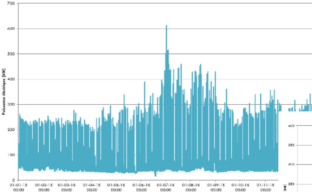
**Puissance électrique 1/4 horaire (Machine froid)**
