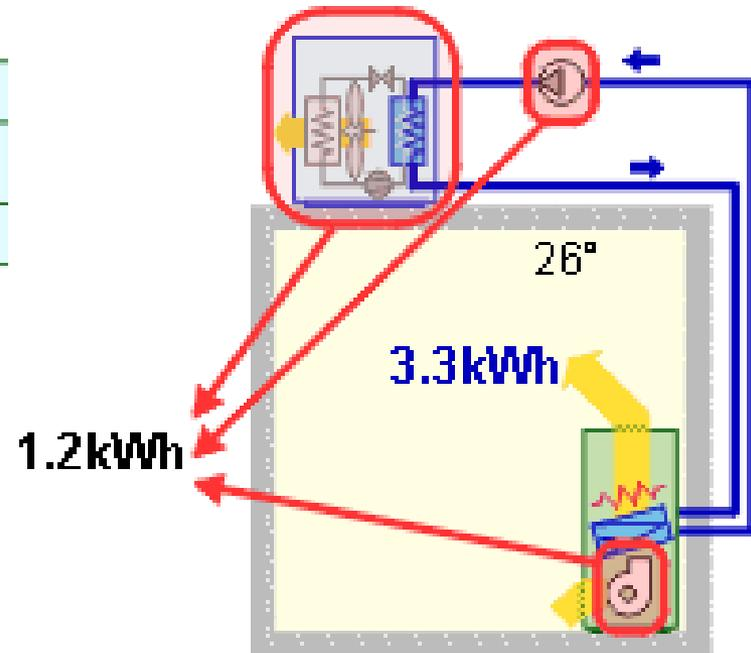
Pour produire 3,3 kWh de froid, on consomme 1,2 kWh électrique avec un COP de 2,75
