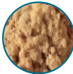
Fibres de bois en vrac \lambda = 0,038 \text{ W/mK}
