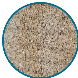
Fibres d'herbe \lambda = 0,04 \text{ W/mK}
