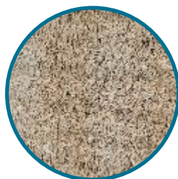
Fibres d'herbe \lambda = 0,04 \text{ W/mK}
