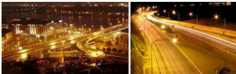
Exemple : Sodium basse pression – Ra ≈ 22
