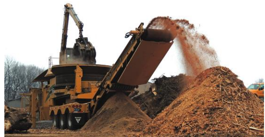
4. Transformation en copeaux de bois (broyage)
