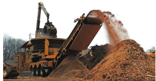
4. Transformation en copeaux de bois (broyage)
