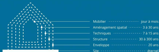
Structuration des couches fonctionnelles en fonction de leur durée de vie
