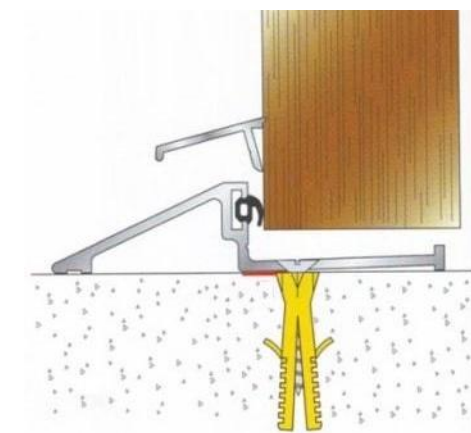
Pièce d'appui (ou seuil suisse)
