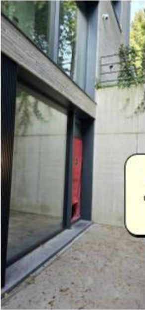
Installation de l'équipement de mesure dans une porte-fenêtre étanche à l'air.
