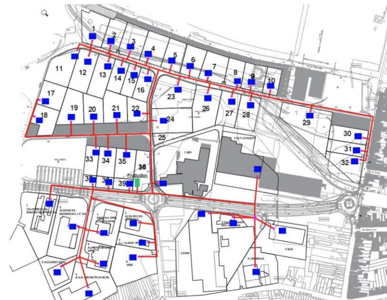
Figure 8 : Schéma du réseau à basse température du zoning LD
