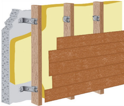
Métal traversant l'isolant
