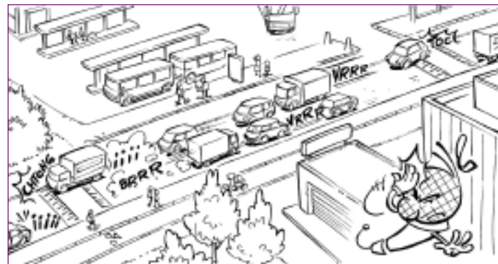
Mauvais exemple : Plateau localisé en un endroit fortement fréquenté par des poids lourds, aucune mesure accompagnatrice, espacement très important entre les dispositifs.
