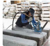
Finition des bordures par bouchardage © Géréria de Bonnaill-sur-Mer
