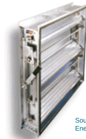
Opposé : Répartition du flux plus uniforme dans la gaine lors de la fermeture
