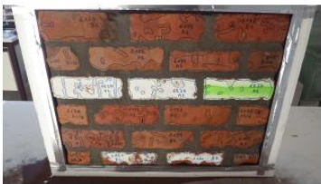
figuur 1 : schets van het paneel (blootgesteld vlak : 570 mm x 440 mm)
