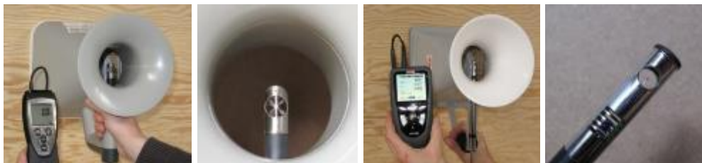
Petite sonde + cône (anémomètre hélice ou thermique)
