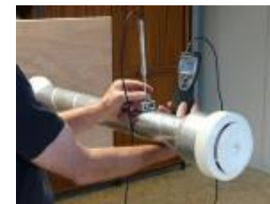
Sonde + conduit au niveau de la bouche
