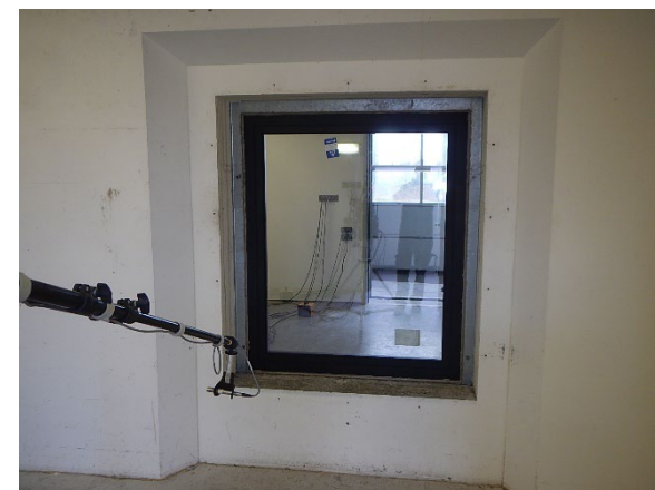
Dispositif d'essai pour des fenêtres 123 x 148
