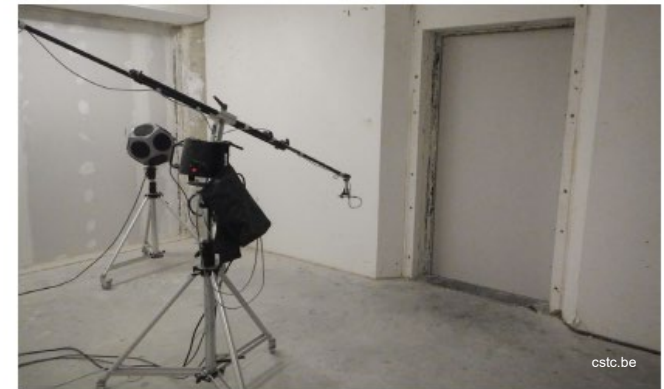
Fig. 82 Ouverture d'essai de 99 x 216 cm pour portes.
