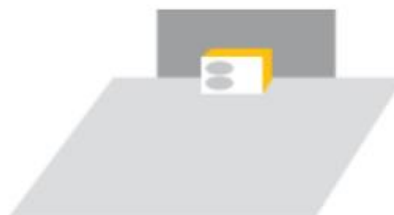
PAC placée contre un mur : + 3 dB(A)
