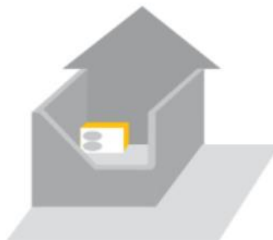
PAC placée dans une cour intérieure : + 9 dB(A)
