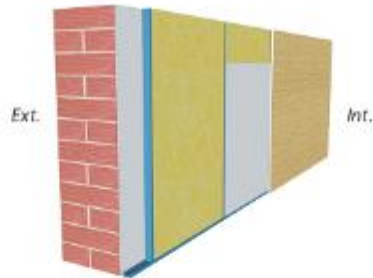
Isolation par l'intérieur
