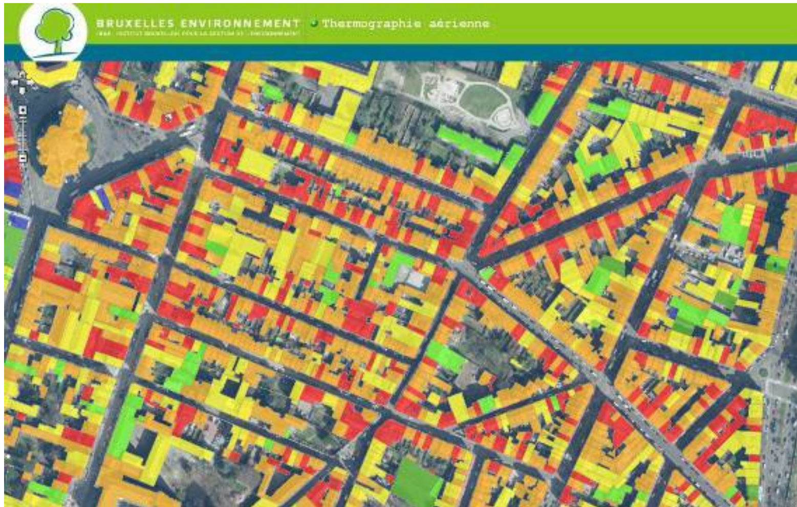
Thermographie aérienne infrarouge des toitures des bâtiments bruxellois Source : Bruxelles Environnement
