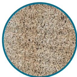
Fibres d'herbe \lambda = 0,04 \text{ W/mK}
