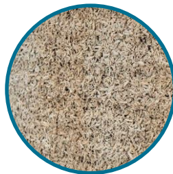
Fibres d'herbe \lambda = 0,04 \text{ W/mK}
