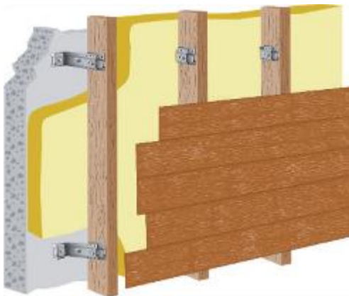
Métal traversant l'isolant
