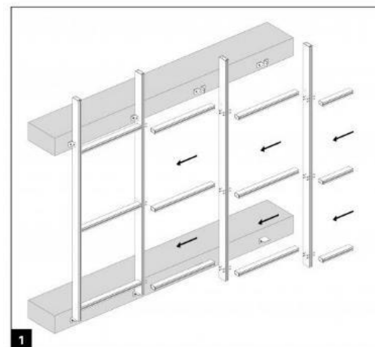
Steckbauweise Méthode de construction modulaire
