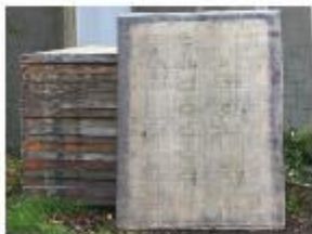
Panneaux de coffrage
