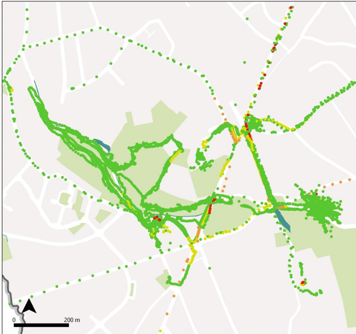
Figure 20 : Contribution locale liée au trafic sur les concentrations totales de Black Carbon (en \mu\text{g}/\text{m}^3 ) mesurées dans le parc Keyenbempt et dans le quartier de ce parc. Points en vert : contribution locale comprise entre 0 et 2 \mu\text{g}/\text{m}^3 . Points en jaune : contribution locale comprise entre 2 et 5 \mu\text{g}/\text{m}^3 . Points en orange : contribution locale comprise entre 5 et 8 \mu\text{g}/\text{m}^3 . Points en rouge : contribution locale supérieure à 8 \mu\text{g}/\text{m}^3 .
