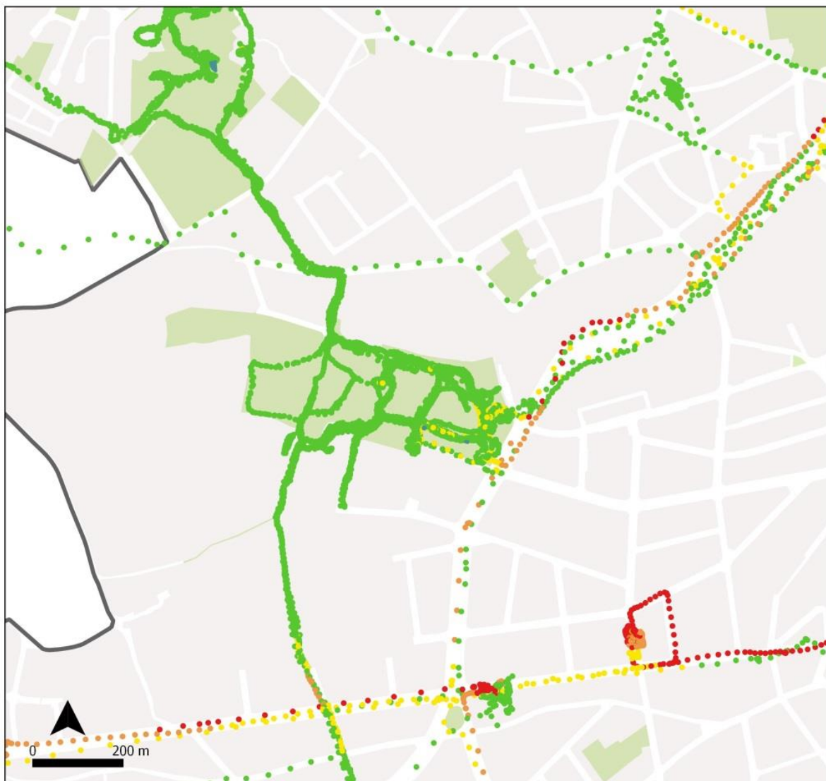
Figure 21 : Concentrations totales de Black Carbon (en \mu\text{g}/\text{m}^3 ) mesurées dans et dans le quartier du parc Scheutbos. Points en vert : concentrations comprises entre 0 et 2 \mu\text{g}/\text{m}^3 . Points en jaune : concentrations comprises entre 2 et 5 \mu\text{g}/\text{m}^3 . Points en orange : concentrations comprises entre 5 et 8 \mu\text{g}/\text{m}^3 . Points en rouge : concentrations supérieures à 8 \mu\text{g}/\text{m}^3 .
