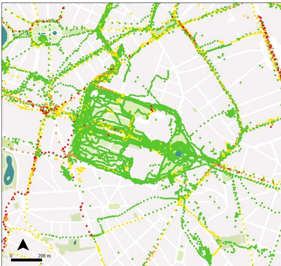
Figure 23 : Concentrations totales de Black Carbon (en \mu\text{g}/\text{m}^3 ) mesurées dans et dans le quartier du parc du Cinquantaire. Points en vert : concentrations comprises entre 0 et 2 \mu\text{g}/\text{m}^3 . Points en jaune : concentrations comprises entre 2 et 5 \mu\text{g}/\text{m}^3 . Points en orange : concentrations comprises entre 5 et 8 \mu\text{g}/\text{m}^3 . Points en rouge : concentrations supérieures à 8 \mu\text{g}/\text{m}^3 .
