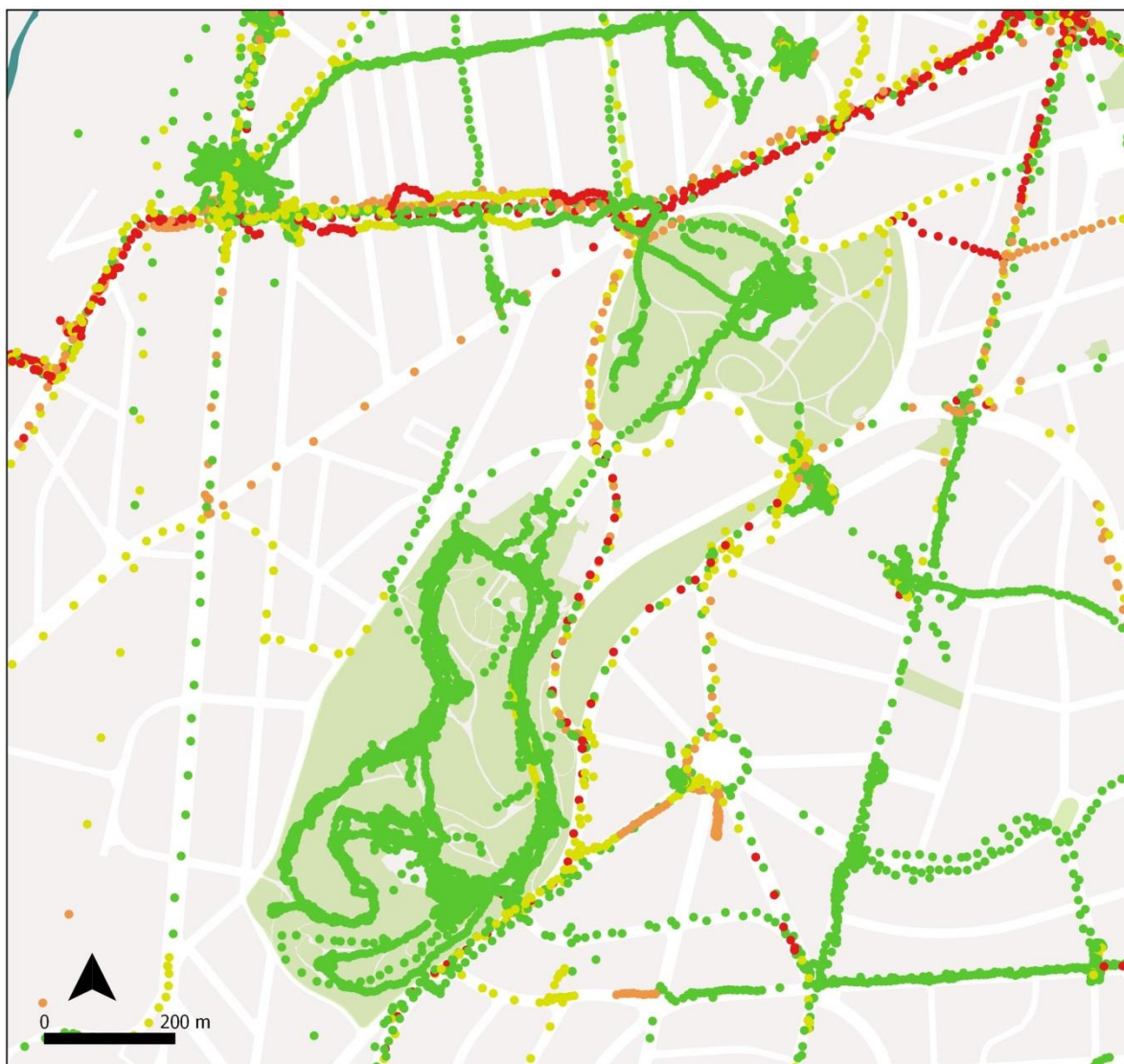
Figure 17 : Contribution locale liée au trafic sur les concentrations totales de Black Carbon (en \mu\text{g}/\text{m}^3 ) mesurées dans le parc Duden et à proximité de ce parc. Points en vert : contribution locale comprise entre 0 et 2 \mu\text{g}/\text{m}^3 . Points en jaune : contribution locale comprise entre 2 et 5 \mu\text{g}/\text{m}^3 . Points en orange : contribution locale comprise entre 5 et 8 \mu\text{g}/\text{m}^3 . Points en rouge : contribution locale supérieure à 8 \mu\text{g}/\text{m}^3 .
