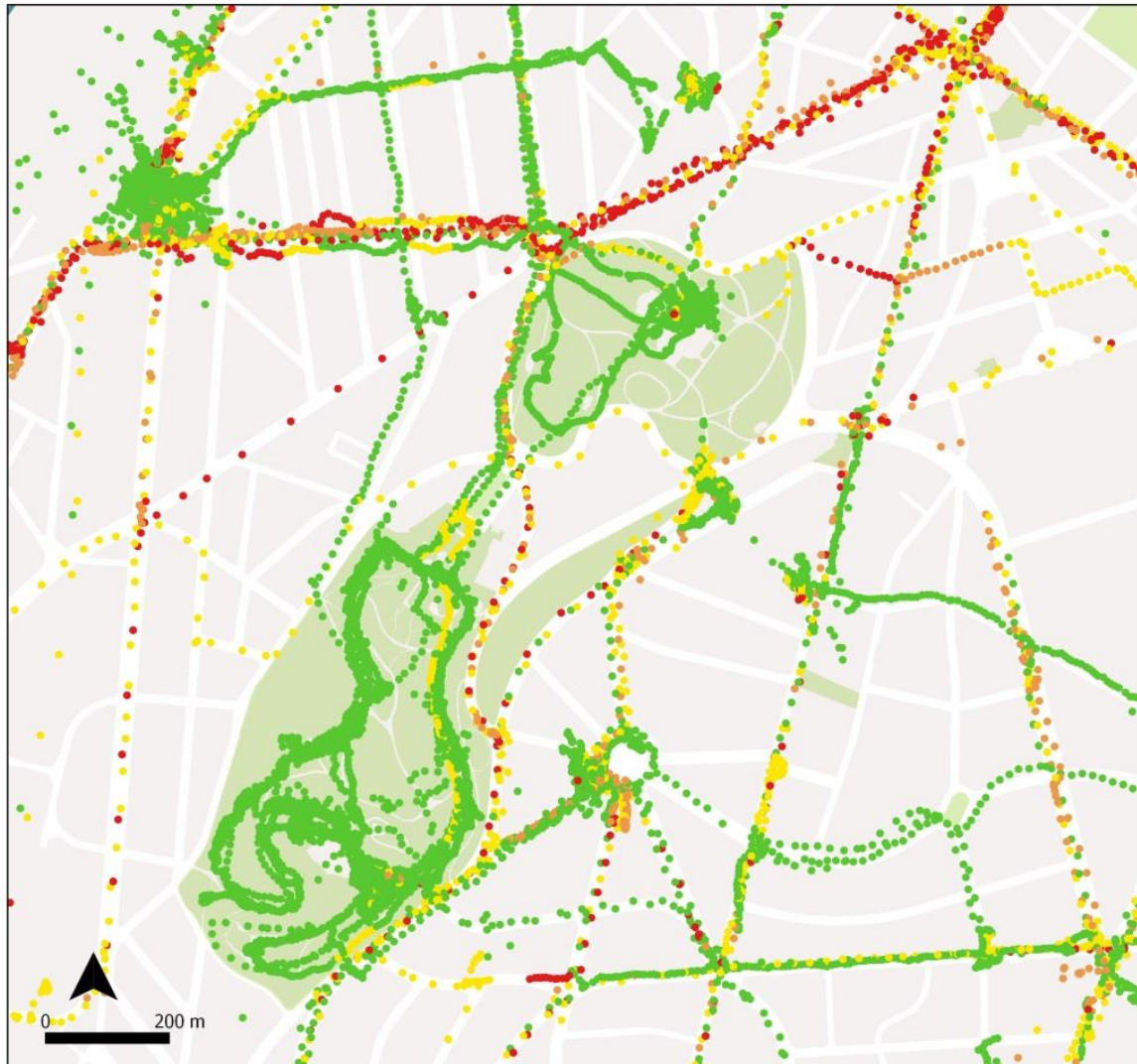
Figure 16 : Concentrations totales de Black Carbon (en \mu\text{g}/\text{m}^3 ) mesurées dans et dans le quartier du parc Duden. Points en vert : concentrations comprises entre 0 et 2 \mu\text{g}/\text{m}^3 . Points en jaune : concentrations comprises entre 2 et 5 \mu\text{g}/\text{m}^3 . Points en orange : concentrations comprises entre 5 et 8 \mu\text{g}/\text{m}^3 . Points en rouge : concentrations supérieures à 8 \mu\text{g}/\text{m}^3 .
