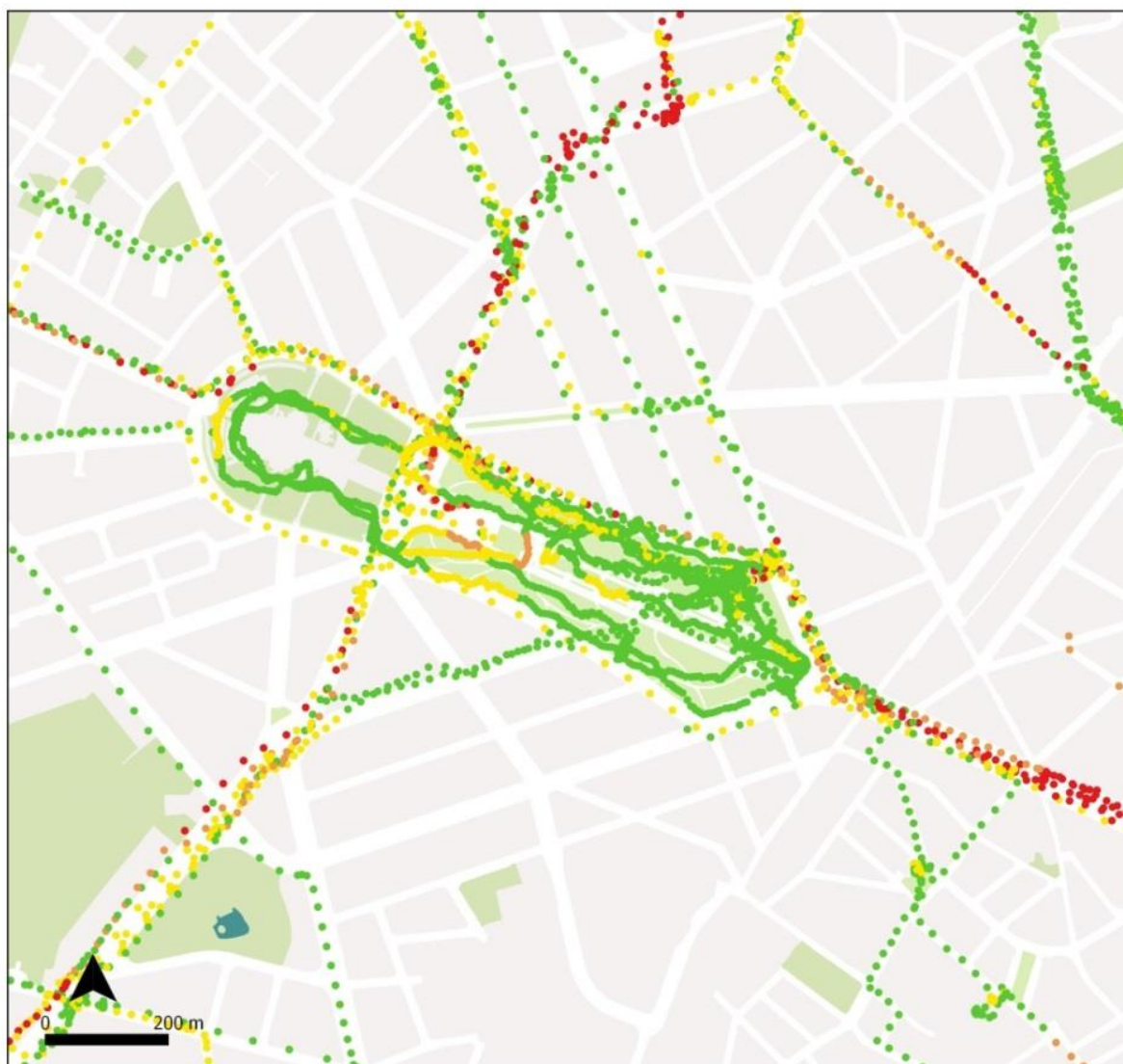
Figure 27 : Concentrations totales de Black Carbon (en \mu\text{g}/\text{m}^3 ) mesurées dans le parc Elisabeth et dans le quartier de ce parc. Points en vert : concentrations comprises entre 0 et 2 \mu\text{g}/\text{m}^3 . Points en jaune : concentrations comprises entre 2 et 5 \mu\text{g}/\text{m}^3 . Points en orange : concentrations comprises entre 5 et 8 \mu\text{g}/\text{m}^3 . Points en rouge : concentrations supérieures à 8 \mu\text{g}/\text{m}^3 .
