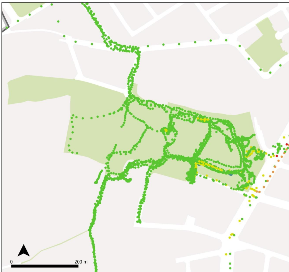
Figure 22 : Contribution locale liée au trafic sur les concentrations totales de Black Carbon (en \mu\text{g}/\text{m}^3 ) mesurées dans le parc Scheutbos et dans le quartier de ce parc. Points en vert : contribution locale comprise entre 0 et 2 \mu\text{g}/\text{m}^3 . Points en jaune : contribution locale comprise entre 2 et 5 \mu\text{g}/\text{m}^3 . Points en orange : contribution locale comprise entre 5 et 8 \mu\text{g}/\text{m}^3 . Points en rouge : contribution locale supérieure à 8 \mu\text{g}/\text{m}^3 .
