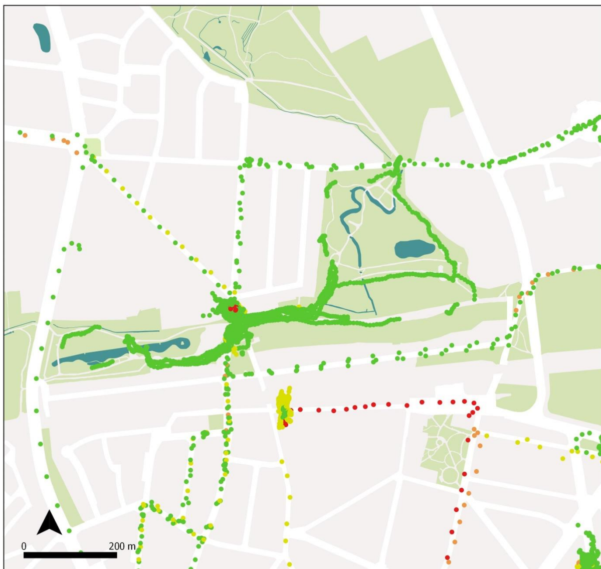
Figure 26 : Contribution locale liée au trafic sur les concentrations totales de Black Carbon (en \mu\text{g}/\text{m}^3 ) mesurées dans le parc Roi Baudouin et dans le quartier de ce parc. Points en vert : contribution locale comprise entre 0 et 2 \mu\text{g}/\text{m}^3 . Points en jaune : contribution locale comprise entre 2 et 5 \mu\text{g}/\text{m}^3 . Points en orange : contribution locale comprise entre 5 et 8 \mu\text{g}/\text{m}^3 . Points en rouge : contribution locale supérieure à 8 \mu\text{g}/\text{m}^3 .
