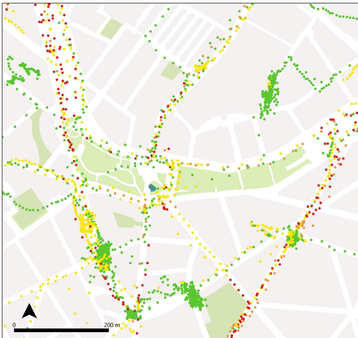
Figure 29 : Concentrations totales de Black Carbon (en \mu\text{g}/\text{m}^3 ) mesurées dans le parc de la Porte de Hal et dans le quartier de ce parc. Points en vert : concentrations comprises entre 0 et 2 \mu\text{g}/\text{m}^3 . Points en jaune : concentrations comprises entre 2 et 5 \mu\text{g}/\text{m}^3 . Points en orange : concentrations comprises entre 5 et 8 \mu\text{g}/\text{m}^3 . Points en rouge : concentrations supérieures à 8 \mu\text{g}/\text{m}^3 .
