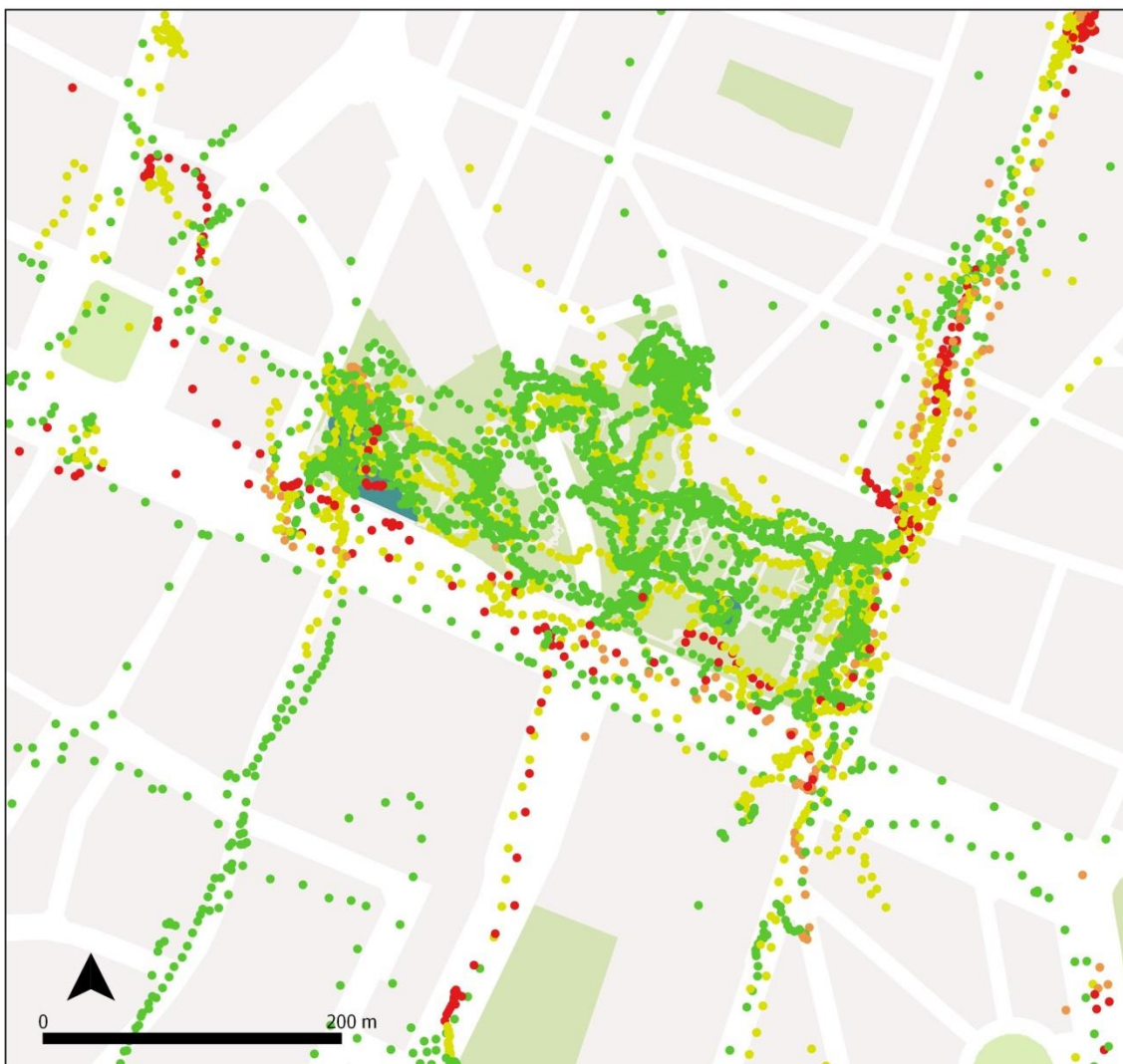
Figure 13 : Contribution locale liée au trafic sur les concentrations totales de Black Carbon (en \mu\text{g}/\text{m}^3 ) mesurées dans le parc du Botanique et à proximité de ce parc. Points en vert : contribution locale comprise entre 0 et 2 \mu\text{g}/\text{m}^3 . Points en jaune : contribution locale comprise entre 2 et 5 \mu\text{g}/\text{m}^3 . Points en orange : contribution locale comprise entre 5 et 8 \mu\text{g}/\text{m}^3 . Points en rouge : contribution locale supérieure à 8 \mu\text{g}/\text{m}^3 .
