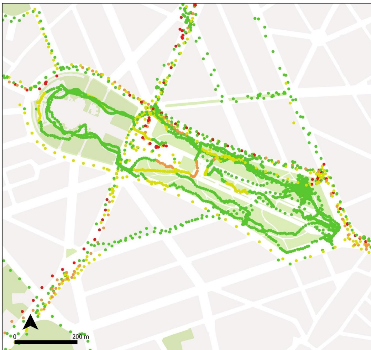
Figure 28 : Contribution locale liée au trafic sur les concentrations totales de Black Carbon (en \mu\text{g}/\text{m}^3 ) mesurées dans le parc Elisabeth et dans le quartier de ce parc. Points en vert : contribution locale comprise entre 0 et 2 \mu\text{g}/\text{m}^3 . Points en jaune : contribution locale comprise entre 2 et 5 \mu\text{g}/\text{m}^3 . Points en orange : contribution locale comprise entre 5 et 8 \mu\text{g}/\text{m}^3 . Points en rouge : contribution locale supérieure à 8 \mu\text{g}/\text{m}^3 .
