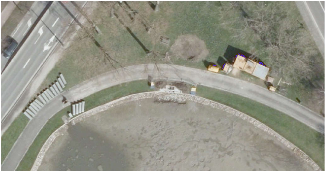
Figure 1-3 - Détail des travaux d'aménagement des berges réalisés en 2009 à l'extrémité nord du grand étang (source : Brugis). Une bordure en bois dur précédée d'une zone empierrée a été placée sur tout le pourtour de l'étang.
