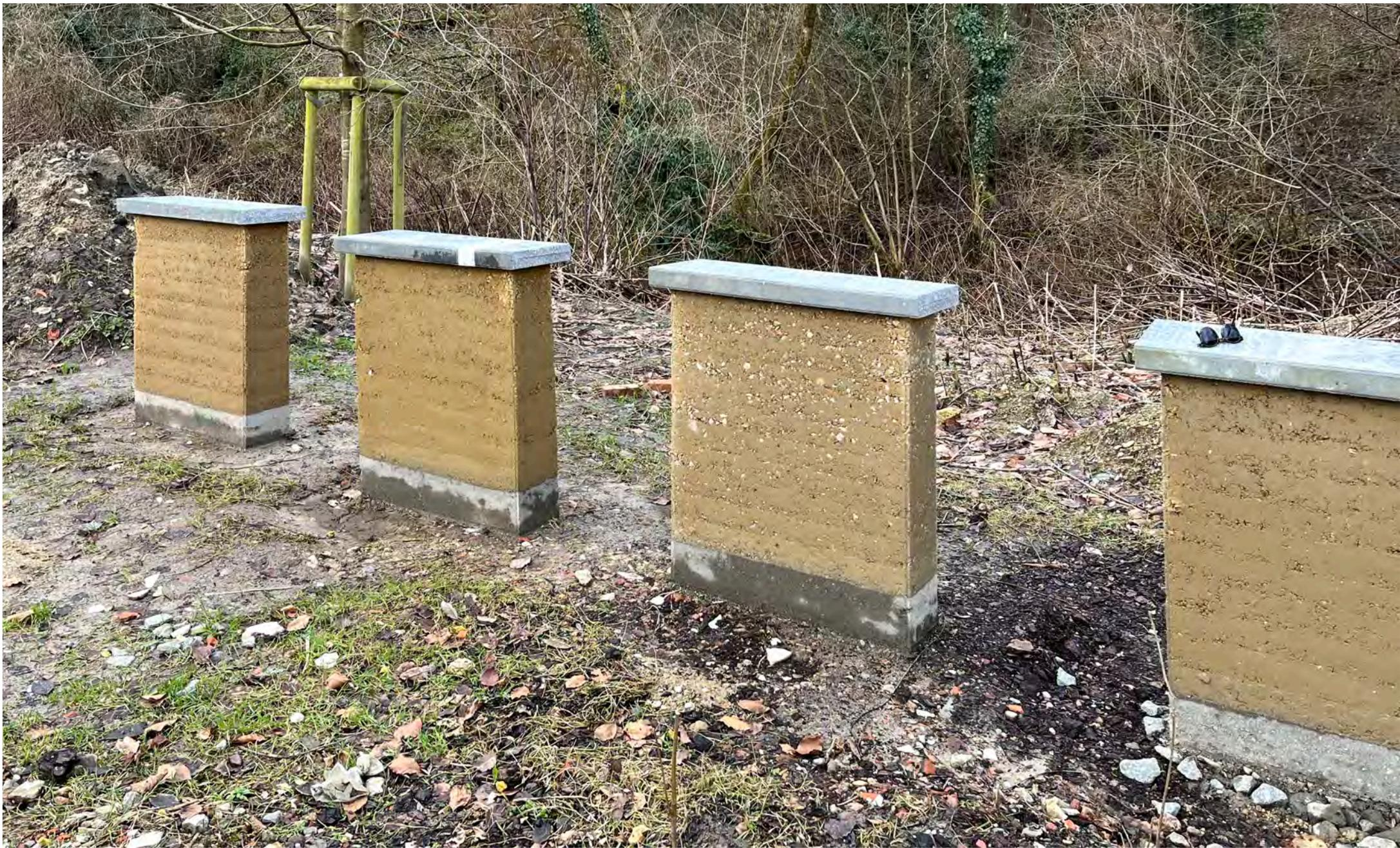
murs d'essai en pisé, test d'érosion sur 1 an
