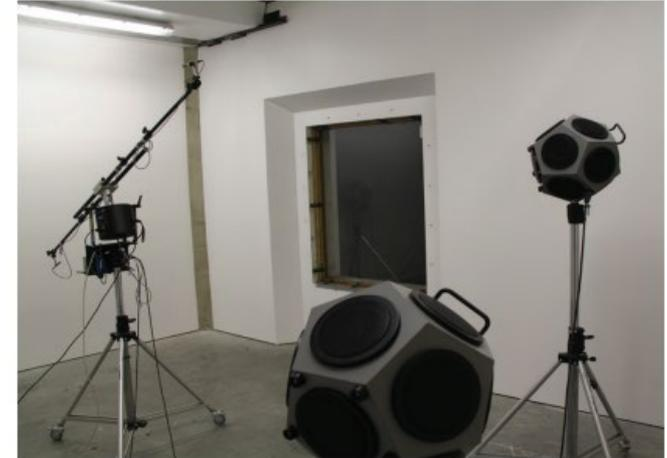
Fig. 80 Ouverture d'essai de 125 x 150 cm pour vitrages, fenêtres et petits panneaux.
