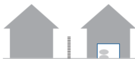
PAC correctement placée
