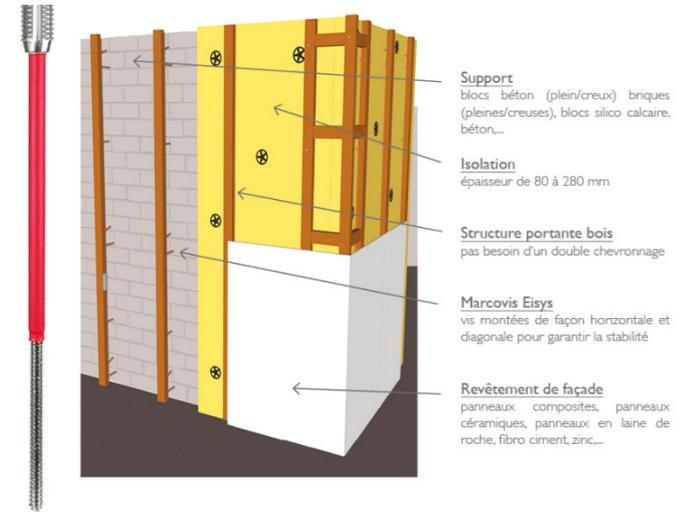
Fixation hybride + section plus faible = moins de pertes thermiques
