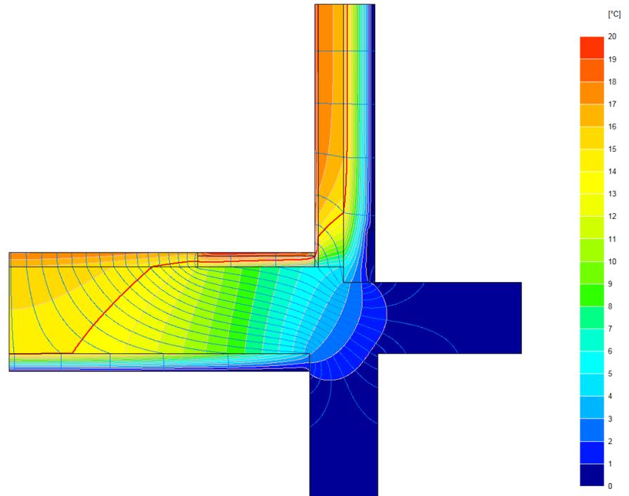
Avec fibres de bois sur le mur intérieur
