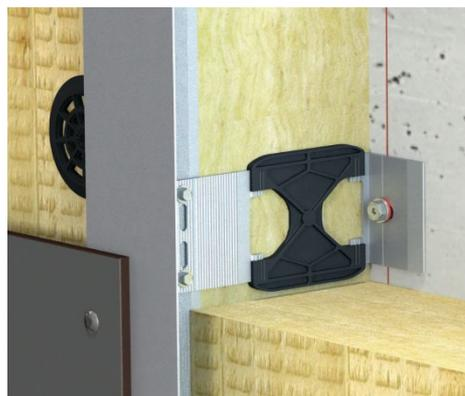
Matériau synthétique traversant l'isolant
