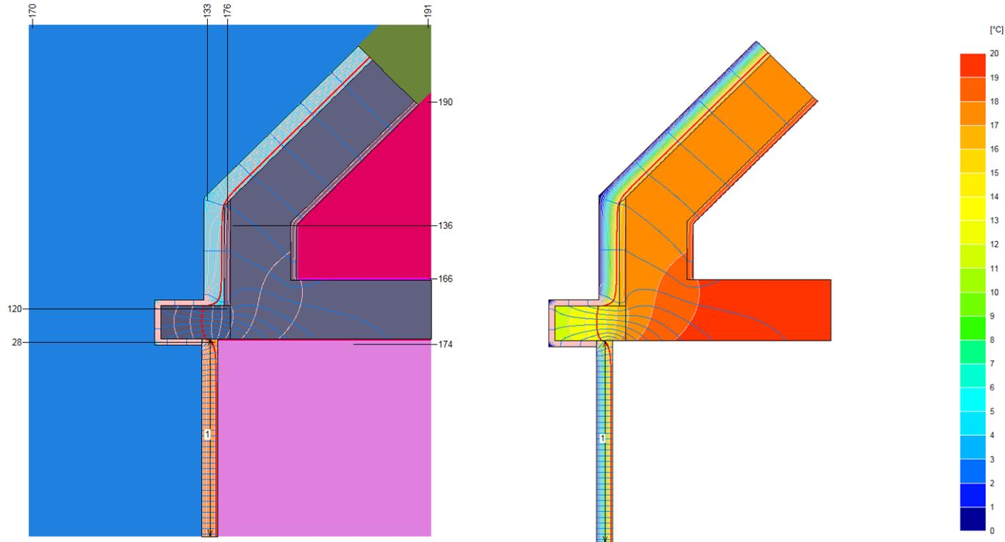
Isolation de la corniche par 3 cm d'isolant type PU minimum
