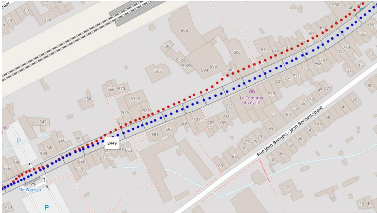
Fig. 6 (a). Mesures. En rouge, les coordonnées issues du récepteur GPS ; en bleu, les coordonnées corrigés par l'algorithme de *snapping* de OSMR. En gris, les polygones dans lesquelles le parcours a été découpé.
