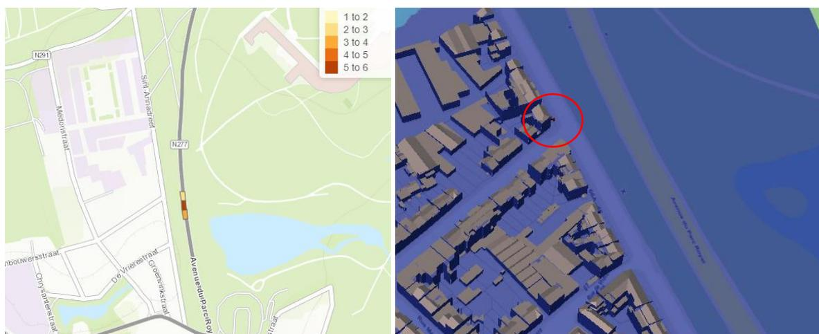
Fig. 8. Mesures aberrantes en V/m (a) par rapport à la simulation (b). Une antenne, cerclée en rouge, existe à l'endroit de la mesure, mais la simulation et les données techniques ne justifient pas la valeur mesurée.
