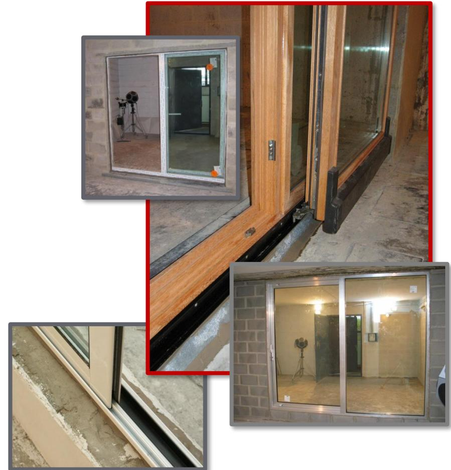
Fenêtres coulissantes améliorées sur le plan acoustique : joints, renforts, systèmes de fermeture
