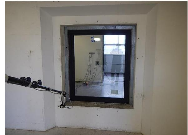
Dispositif d'essai pour des fenêtres
