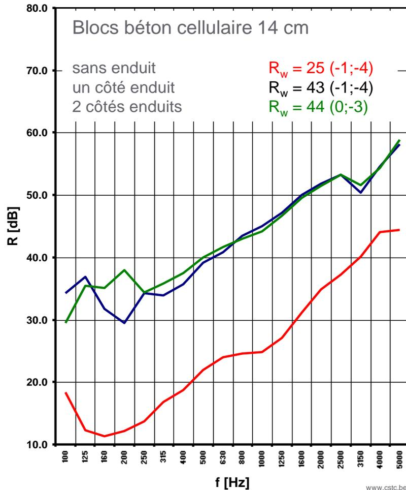
L'enduit a une très grande influence sur l'indice d'affaiblissement acoustique des blocs maçonnés. Plus ils sont poreux (p.ex. blocs de béton d'argile expansé), plus ce phénomène sera marqué. L'enduit d'une seule des deux faces suffit la plupart du temps. Son épaisseur a assez peu d'importance.
