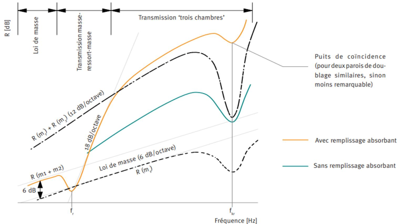
Fig. 92 Évolution schématique de l'indice d'affaiblissement acoustique des doubles parois.
