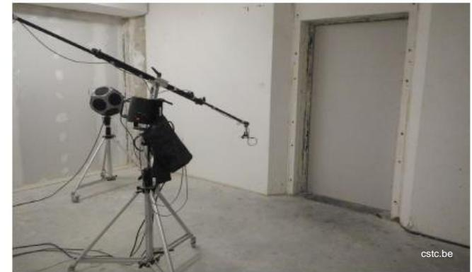
Fig. 82 Ouverture d'essai de 99 x 216 cm pour portes.
