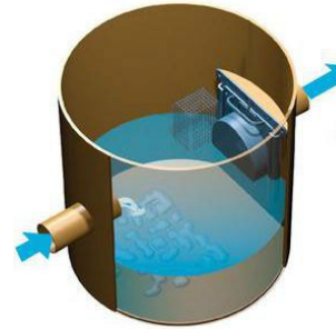
Rejet à débit régulé
