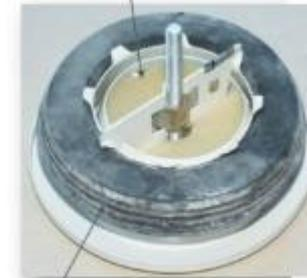
Étanchéité acoustique du joint
