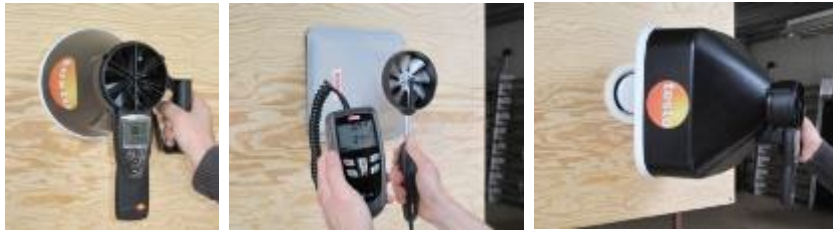
Anémomètre à hélice (petit ou grand cône)
