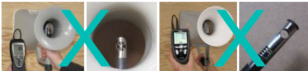
Petite sonde + cône (anémomètre hélice ou thermique)
