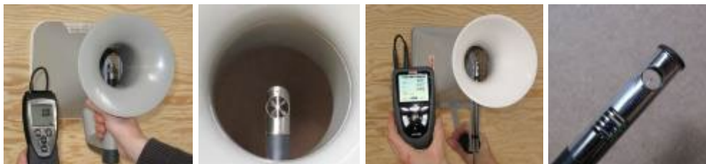
Petite sonde + cône (anémomètre hélice ou thermique)
