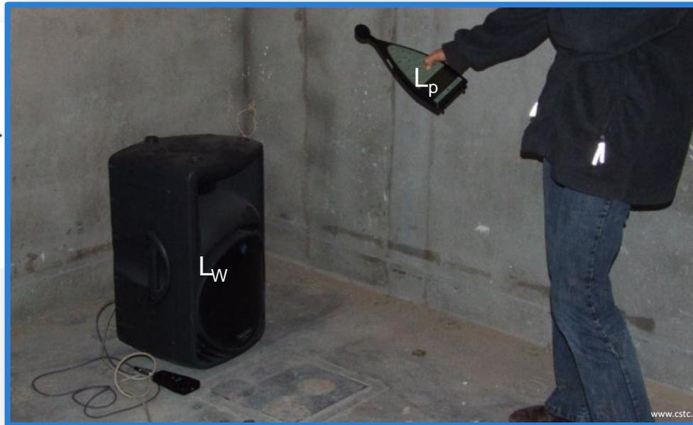
Attention de ne pas confondre  $L_w$  et  $L_p$  ! Analogie de l'ampoule électrique
