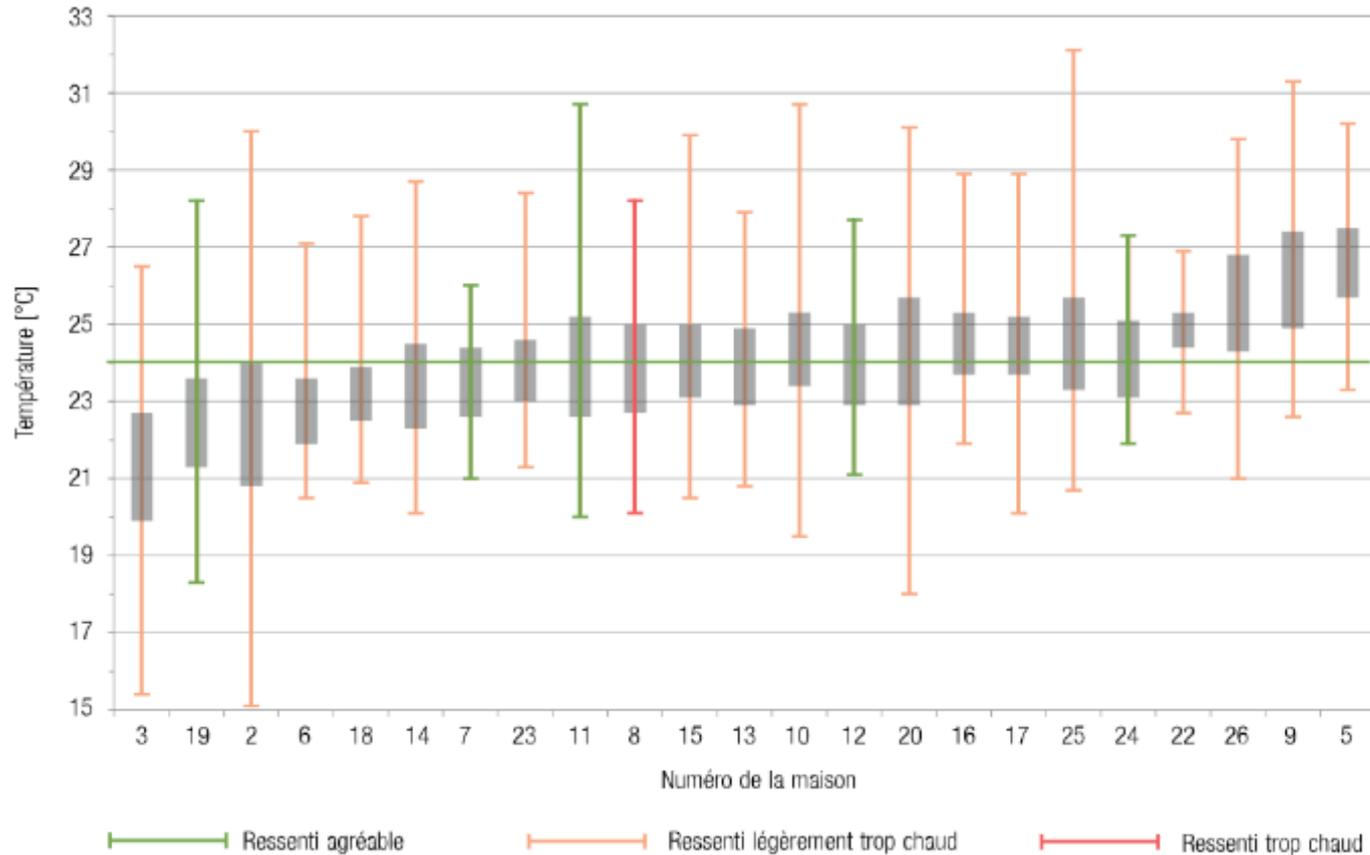
Température intérieure dans des chambres à coucher parentales, mesurées de 22h à 6h du 21/06 au 22/09/2016.
