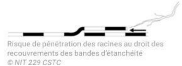
**Par rapport à une toiture plate courante, la toiture verte se distingue par une moindre accessibilité de l'étanchéité. La recherche d'une fuite éventuelle s'avérera d'autant plus difficile, longue et coûteuse que le système de toiture verte est épais. Le plus grand soin doit donc être apporté à la réalisation de l'étanchéité et à la jonction des lés, points de passage préférentiels pour les racines en cas de défaut. (CSTC, NIT 229)**
